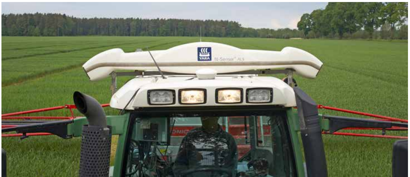
Yara N-Sensor är monterad på traktorns tak. På rampen sitter fyra kvävesensorer som tillsammans skannar 50 m 2 av fältet i sekunden. Yara N-Sensor ALS, se bilden, har en egen inbyggd ljuskälla som skickar ut blixtrar med infrarött ljus 20 gånger per sekund. Det gör att den kan användas dygnet runt.
