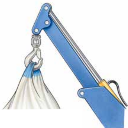
Storsäcken hanteras med hjälp av lyftkrok.
