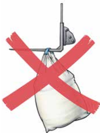
OBS! Använd ej pallgaffel eftersom den kan skada säcken.
