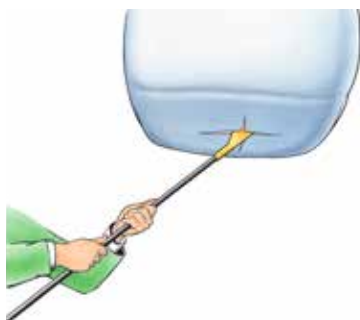
Storsäcken töms genom två korslagda snitt mitt i botten. Snittlängd 30–40 cm.
